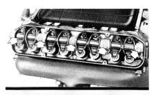
TIGHTEN HOLD-DOWN BOLTS 30 FOOT-POUNDS TORQUE
